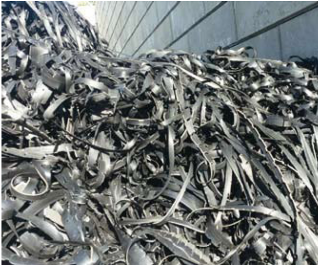
Schälsschlangen von Lkw-Altreifen: Diese werden bei Kurz in der Gummifeinvermahlungsanlage innerhalb weniger Minuten zu groben Chips und dann weiter zu Feinmehl zerkleinert.
