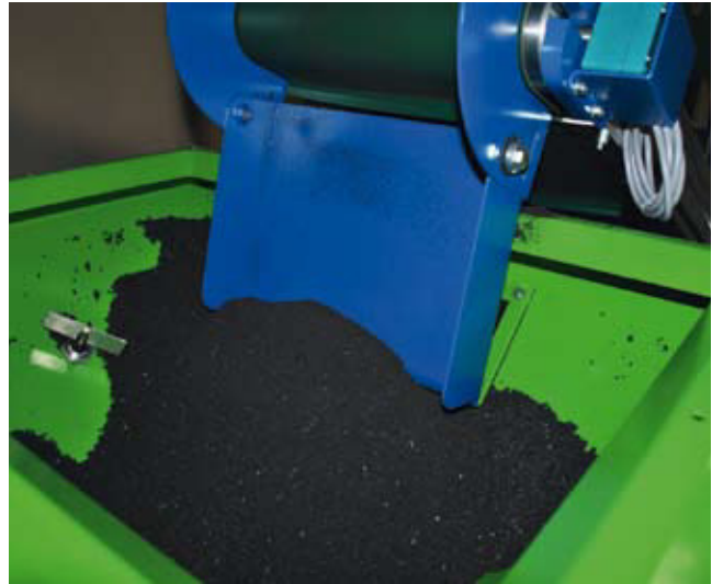
Verwerten statt verbrennen: Das aus Altreifen gewonnene Feinmehl kann dann u.a. als Rohstoff für gummimodifizierten Asphalt weiterverwendet werden.
