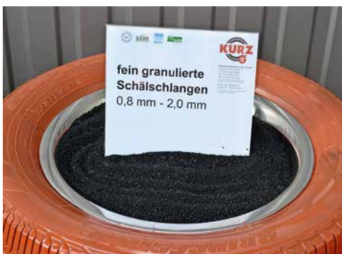
3. Schritt: kleiner granulieren
